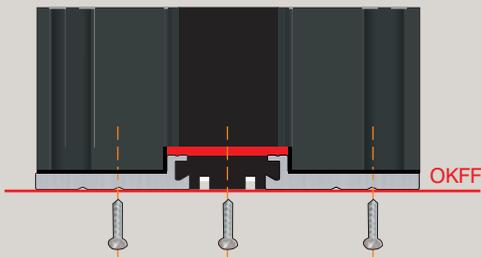
Bodenstatikprofil in EV1 mit der Positionierungsnut und dem Abdichtungsband Serienmäßig. Unten mit einem optimalen Querschnitt garantiert eine absolut formstabile Konstruktion unserer Türen, die sehr wichtig für den Transport und eine schnelle und genaue Montage ist.
